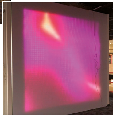
Die Folienbahnen werden mit Klettband aufgeklebt, miteinander verbunden und mit Content bespielt.
